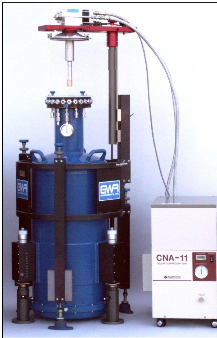
OSG的杜瓦，隔振架和coldhead低温制冷机
